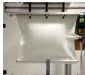
Durch Aufblasen einer nur 20x20 cm großen Kammer mit einem Druck von unter 0,5 bar kann eine massive Edelstahlstange problemlos verbogen werden
