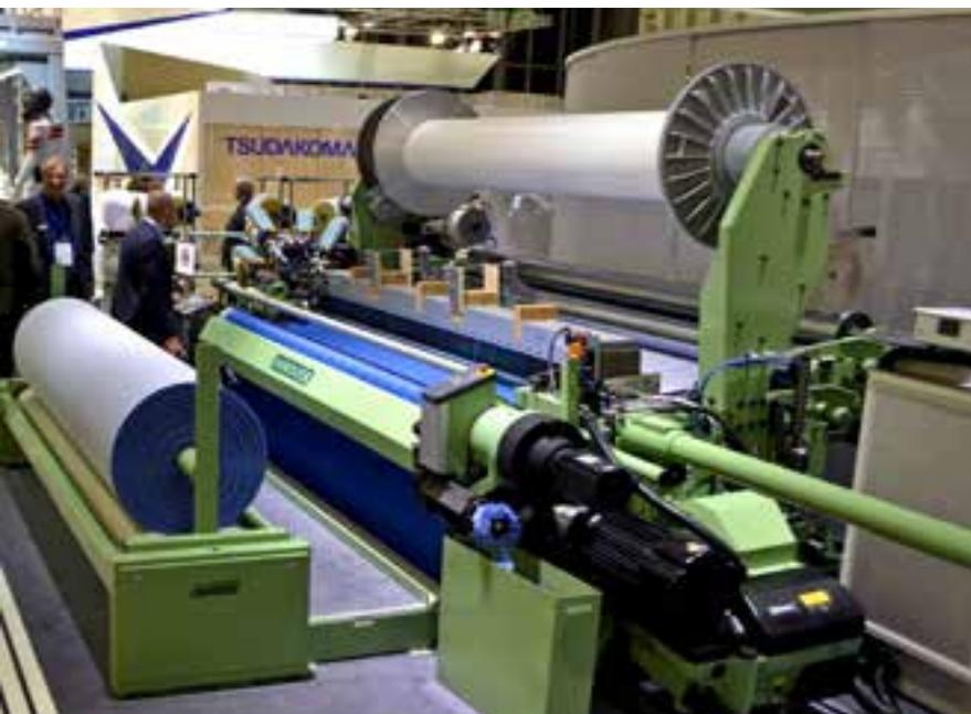
Schwerwebmaschine für Filtergewebe von Dornier
