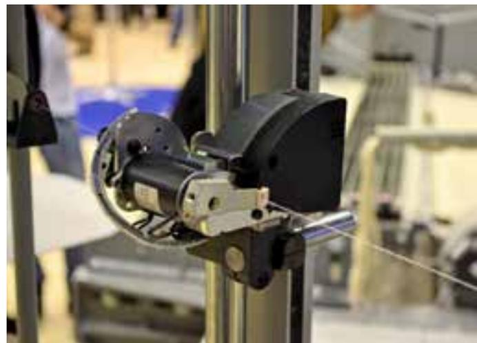
Sensor zur Feinjustierung der Luftdüsen von Toyota und Uster
