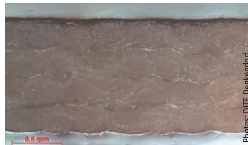
Purcell-Verbundplatte (Querschnitt), aufgebaut aus 4 Gewebelagen
