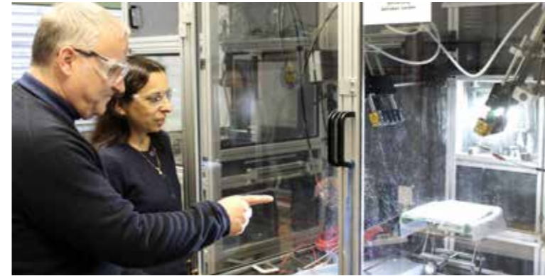
Prof. Dr. Andreas Greiner und Prof. Dr. Seema Agarwal (v.l.) an einer Anlage zum Elektrosplennen an der Universität Bayreuth. Im Gegenlicht sind die dünnen Fasern zu erkennen, aus denen die Vliesstoffe gebildet werden. © Christian Wißler
